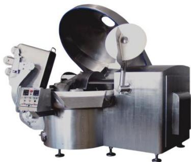
Высокоскоростной куттер вакуумный А170-200 с объемом чаши 0,200 м<sup>3</sup> предназначен для тонкого измельчения всех сортов мяса и перемешивания его с добавочными компонентами под вакуумом при изготовлении всех видов колбас, сосисок и сарделек. Основным преимуществом использования вакуума является повышенный выход готовой продукции без ухудшения вкусовых качеств и более плотная и качественная набивка батонов.
